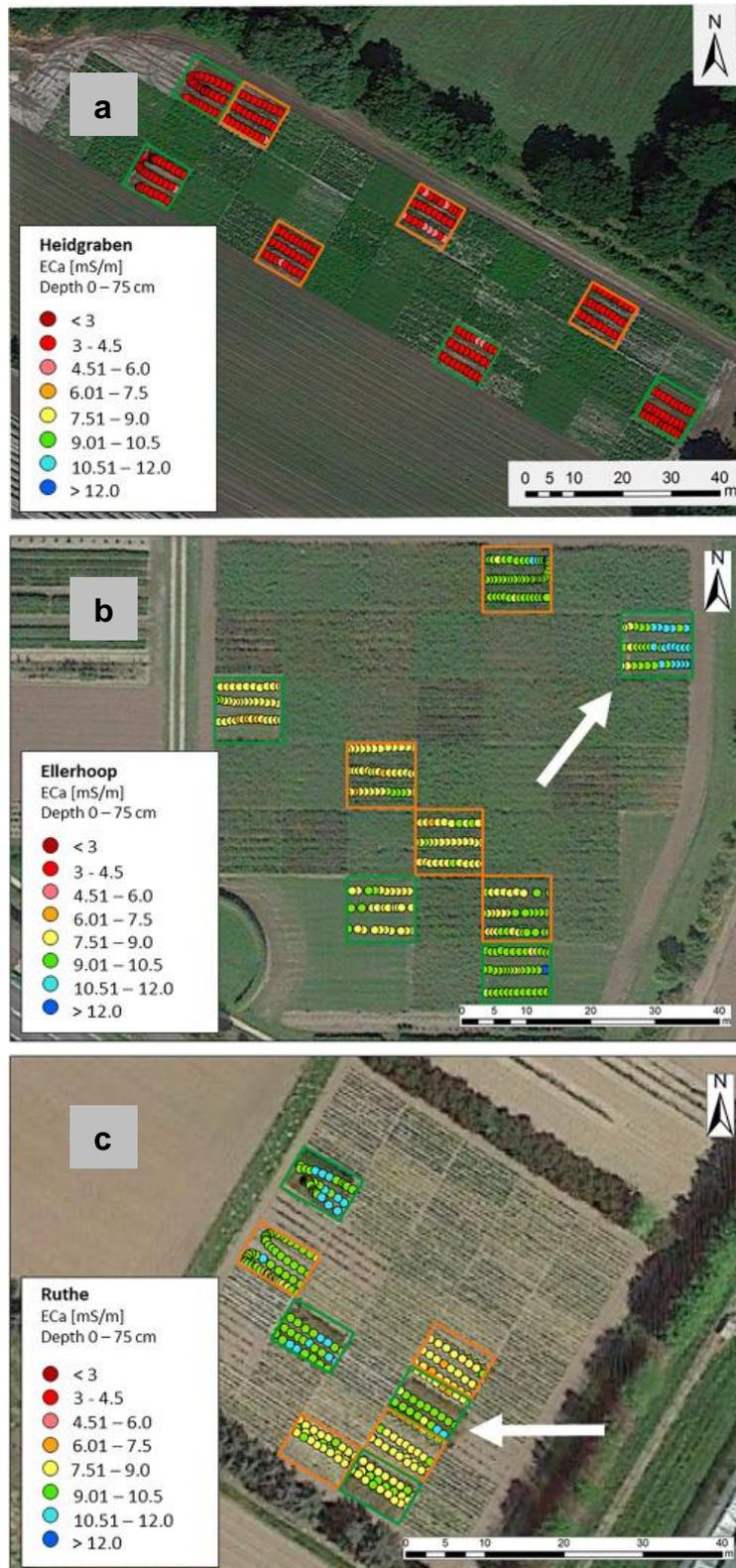
**Abb. 2:** Hochaufgelöste räumliche Analyse der Bodenleitfähigkeit, die die Unterschiede in der Textur der Böden widerspiegelt. Abb. a, b, c: die 3 Standorte Heidgraben, Ellerhoop und Ruthe, Flächen mit ARD sind orange umrandet, Flächen mit Gras sind grün umrandet, die elektrische Leitfähigkeit (ECa) spiegelt Variationen in den Bodeneigenschaften wider (aus MAHNKOPP et al., 2018)
