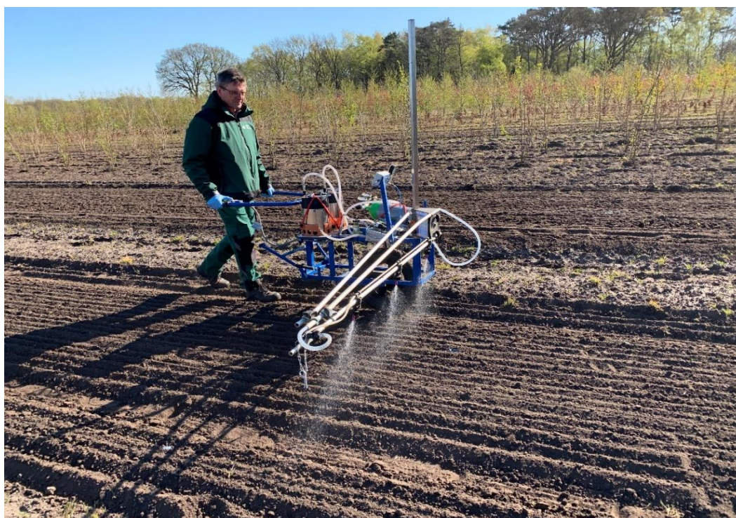
Abb. 5: Parzellenspritzgerät der LKSH auf der Versuchsfläche in Holm im Einsatz, mit dem ProGrow 900 Plus (Var. 4, Aufwandmenge 7 l/ha in 1000 l Wasser) und ProGrow PRX 319 (Var. 6, Aufwandmenge 2 x 4 l/ha in 1000 l Wasser im Abstand von 10 Tagen), beides Biostimulantien, die das Pflanzenwachstum und das Bodenleben fördern sollen, in der geforderten Aufwandmenge 2020 und 2021 appliziert wurden. Im Jahr 2021 wurde auch das Mittel KarDox-TERRAM damit ausgebracht
