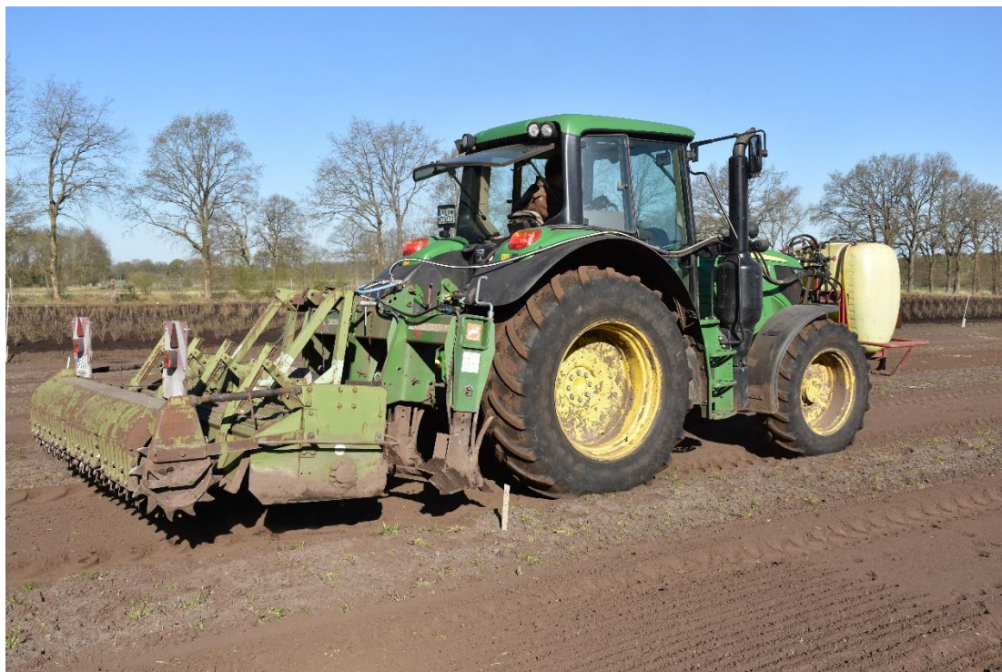
Abb. 4: Spezialgerät zur Applikation von ProGrow KarDox-TERRAM (im Fronttank). Mit dem Gerät wurde das Desinfektionsmittel, kurz vor der Bepflanzung der Parzellen mit Malus , im Frühjahr 2020 in den Boden appliziert und eingearbeitet, wobei die Aufwandmenge bei 50 l/ha in 200 l Wasser gelegen hat
